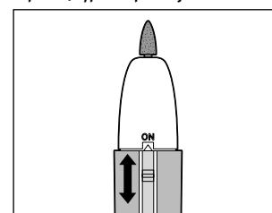
▷ **Zapnutie:** Spínač zap./vyp. posuňte nahor až nadoraz.
