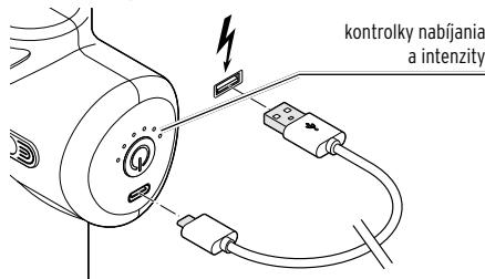
1. Zapojte konektor dodaného USB-C nabíjacieho kábla do nabíjacej zástrčky na prístroji.
