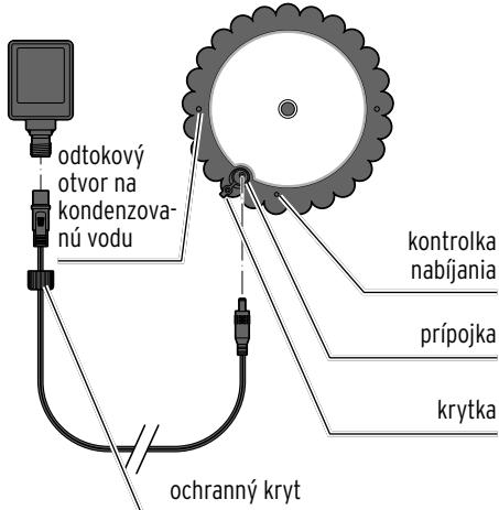
2. Zasuňte jeden koniec prípojného kábla do prípojky na spodnej strane tienidla lampy a druhý koniec do prípojky na sieťovom adaptéri. Ochranný kryt pevne utiahnite.
