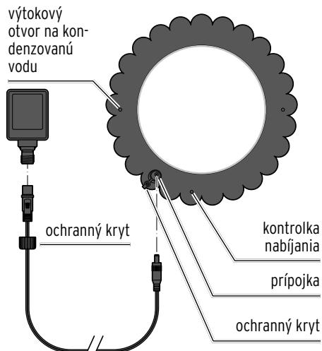
2. Zasuňte jeden koniec prípojného kábla do prípojky na spodnej strane tienidla lampy a druhý koniec do prípojky na sieťovom adaptéri. Ochranný kryt pevne utiahnite.
